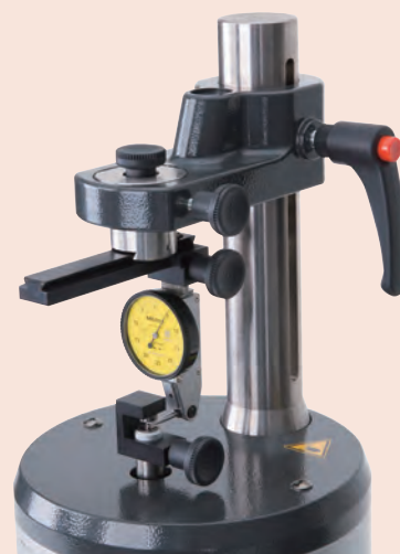
Калибровка рычажно-зубчатых индикаторов с дополнительными принадлежностями
