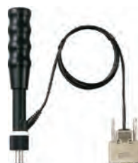
Детектор UD-413 Тип HLD+15 Используется для деталей, имеющих вонутую поверхность, таких как зубья шестерен, подшипники и т.д.
