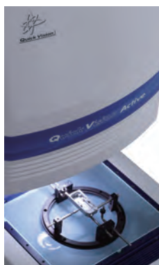
ВИМ QV ACTIVE с дополнительной системой крепления деталей Opti-fix
