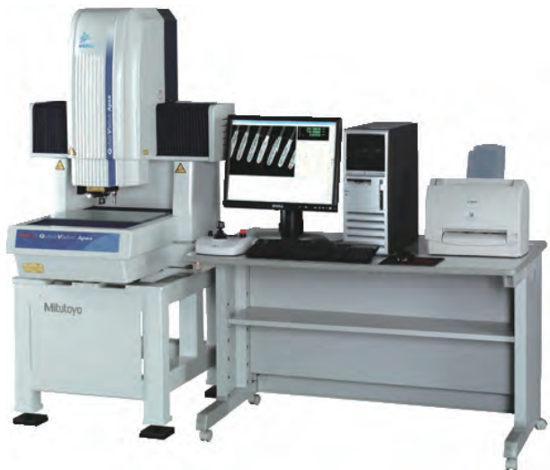
Quick Vision-APEX с дополнительным контактным датчиком
