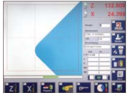
Динамическое перекрестие и автоматическое распознавание диапазона измерения
