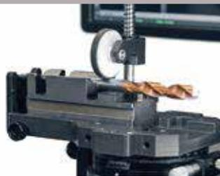
Поворотный стол и V-блок в положении для аксиального измерения
