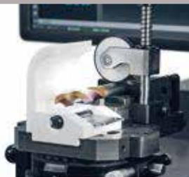
Поворотный стол, развернутый на 90 град. по часовой стрелке (с отражателем) для радиального измерения
