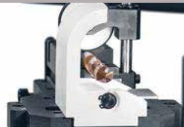
Поворотный стол в положении 45 град. для измерения режущих кромок
