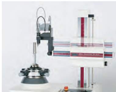
Измерение в процессе слежения по оси X
