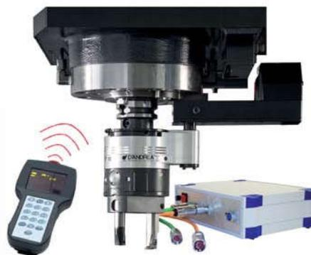
**BZ** Jakékoliv nasazení na stroje nedovolující připojení na osu NC lze provést ovládním motoru U-DRIVE pomocí praktického, jednoduchého a úsporného polohovacího zařízení U-CONTROL s bezdrátovým dálkovým ovládním REMOTE-CONTROL. Polohovací zařízení lze připojit na M funkce stroje a tak získávat signály pro startování různých operací naprogramovaných v REMOTE-CONTROL. **Sférické obrábění není možné u strojů vybavených bezdrátovou soupravou U-CONTROL WIRELESS KIT.**
