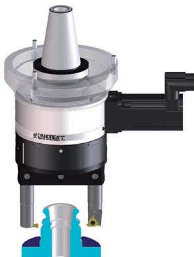
**CZ** Vytvářací hlavy a lícní desky TA-Tronic lze používat manuálně nebo automaticky na malých vrtacích strojích, obráběcích centrech a speciálních strojích. Připojení na vřeteno obráběcího stroje se odehrává pomocí kužele pro rotaci rotační hlavy a příruby pro upevnění pevného dílu na fixní část stroje. Pro jednodušší operace lze použít jednoduchý antirotační kolík.
