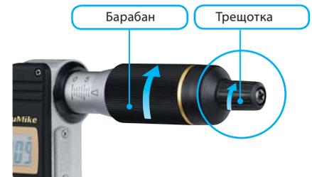
Микроколебания вдоль шпинделя, вызванные трещоткой, обеспечивают повторяемость измерений
