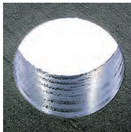
Отверстие D = 6,35 мм не ненаправленное CFK с оптимальным качеством обработки
