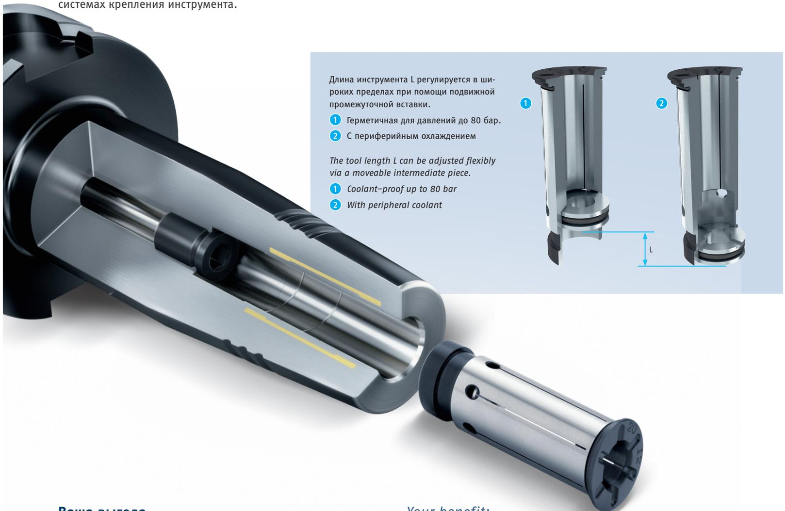
Длина инструмента L регулируется в широких пределах при помощи подвижной промежуточной вставки.
