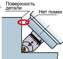
Более точное положение режущей кромки благодаря центрированию по оси шпинделя.
