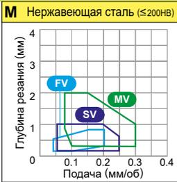
Условия резания : ● : Стабильное резание ● : Предельное резание ✦ : Нестабильное резание
