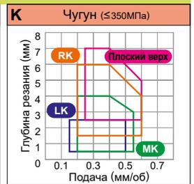
Условия резания : ● : Стабильное резание ● : Предельное резание ✦ : Нестабильное резание
