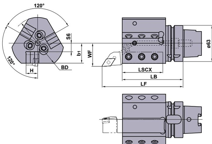
■ Данная державка предназначена для инструмента размерами 20×20.
