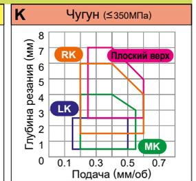
Условия резания : ● : Стабильное резание ● : Предельное резание ✦ : Нестабильное резание
