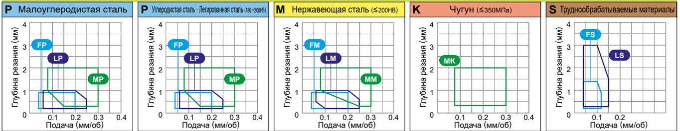
FS, LS : Класс G сменных режущих пластин
