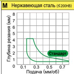
Условия резания : ● : Стабильное резание ● : Предельное резание ✚ : Нестабильное резание
