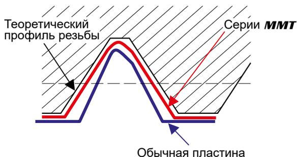
Высокая точность нарезания резьбы достигается использованием пластин, имеющих шлифованную переднюю поверхность и вспомогательную режущую кромку.
