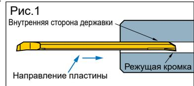
② При использовании этого типа державки может возникнуть опасность повреждения стержня и второй режущей кромки. Убедитесь, что крепежные винты затянуты на установленную величину. Убедитесь, чтобы крепежный винт не попал на вторую режущую кромку, что может привести к поломке расточного инструмента.
