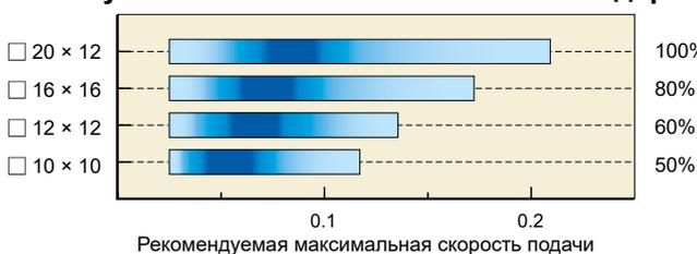
Сверьтесь с таблицами, приведенными выше, для определения рекомендуемых условий резания при обработке наружных канавок. Применяйте процентное соотношение, показанное для каждого размера хвостовика, со значениями в таблице.
