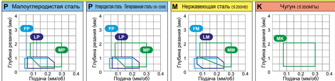
Условия резания : ● : Стабильное резание ● : Предельное резание ✦ : Нестабильное резание
