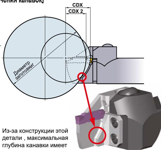
Из-за конструкции этой детали, максимальная глубина канавки имеет ограничение в зависимости от диаметра заготовки
