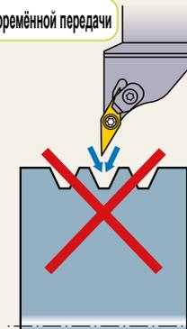
При обработке шкивов клиноременной передачи следует использовать режущую пластину VNMG.
