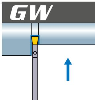
Для наружной отрезки / обработки наружных канавок
