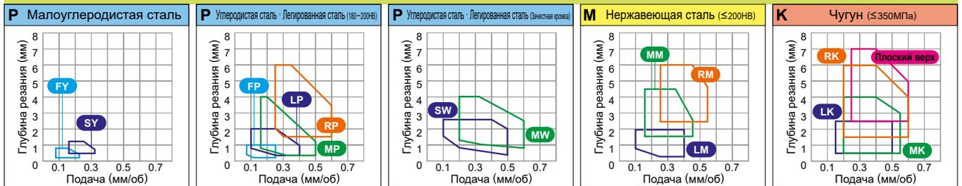
Условия резания : ● : Стабильное резание ● : Предельное резание ✦ : Нестабильное резание
