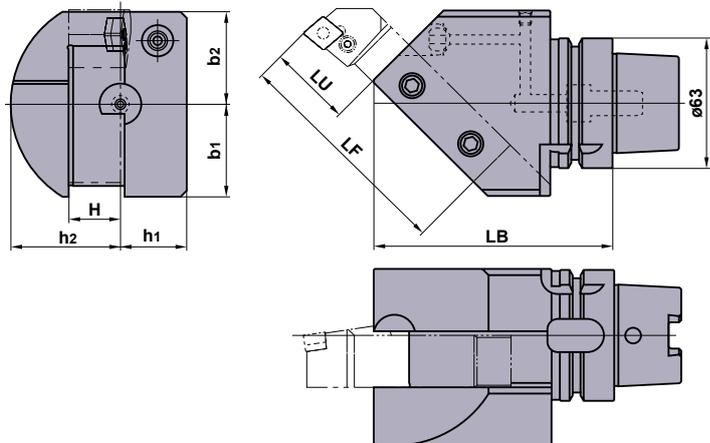
■ Данная державка предназначена для инструмента размерами 25×25.
