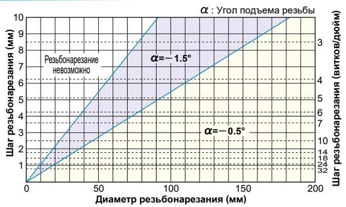
(Примечание) Если угол установки для резьбы  $\leq$  заднего угла инструмента, то для предотвращения бокового столкновения со сменной режущей пластинкой смените подкладную пластинку. (Расчет угла установки для резьбы и заднего угла инструмента смотри в таблице ниже.)
