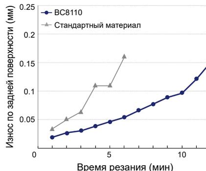
Обеспечивает длительный срок службы инструмента при непрерывном резании закаленной стали.
