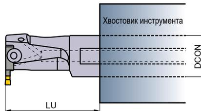
ОТРЕЗНОЙ И КАНАВОЧНЫЙ ИНСТРУМЕНТ
